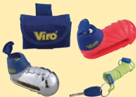
Corpo monolitico, con asta in acciaio temprato, ramato, nichelato e cromato Ø 5,5 o 10 mm. La particolare forma "a scaglie" del corpo rende praticamente impossibile serrarlo con strumenti da morsa per forzarlo.
